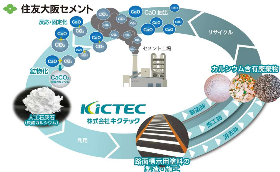
図1 路面標示用塗料を用いたサーキュラーエコノミーシステム
