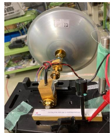
図1 無線受信機の構成 (アンテナ直径約 16cm)
