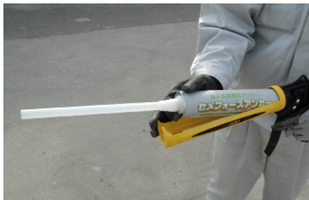
写真2. 専用カートリッジをコーキングガンに装着した状況
