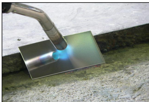
バーナー焼成によるステンレスの変色試験 (左:未処理 右:親水膜)
