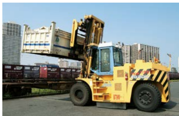
コンテナ積込作業(専用コンテナの最大積載量=10t)
