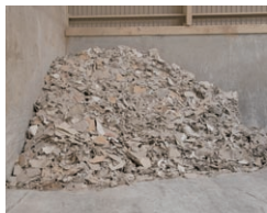
建築廃材から得る石膏ボードは原材料として使用される
